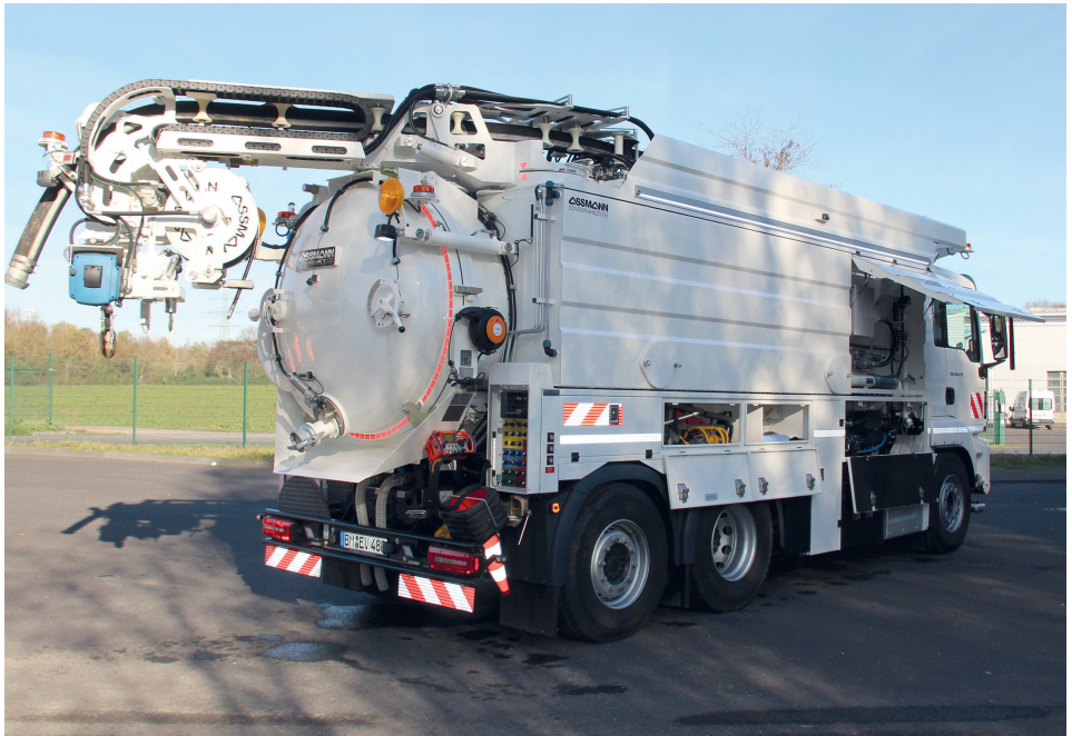
Kanalreinigungsfahrzeug mit Wasser-Rückgewinnungstechnik
