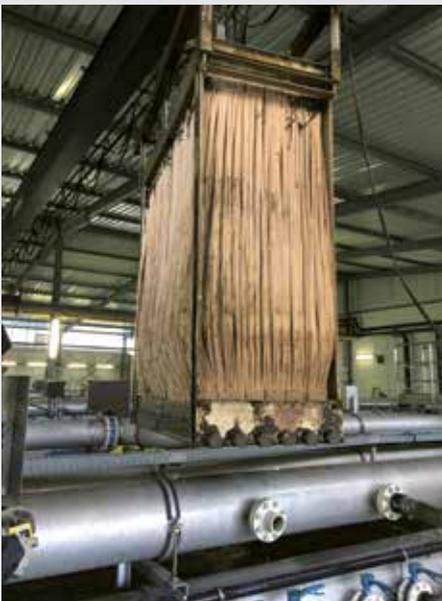
Membranfilterkassette seit 2004 in Betrieb
