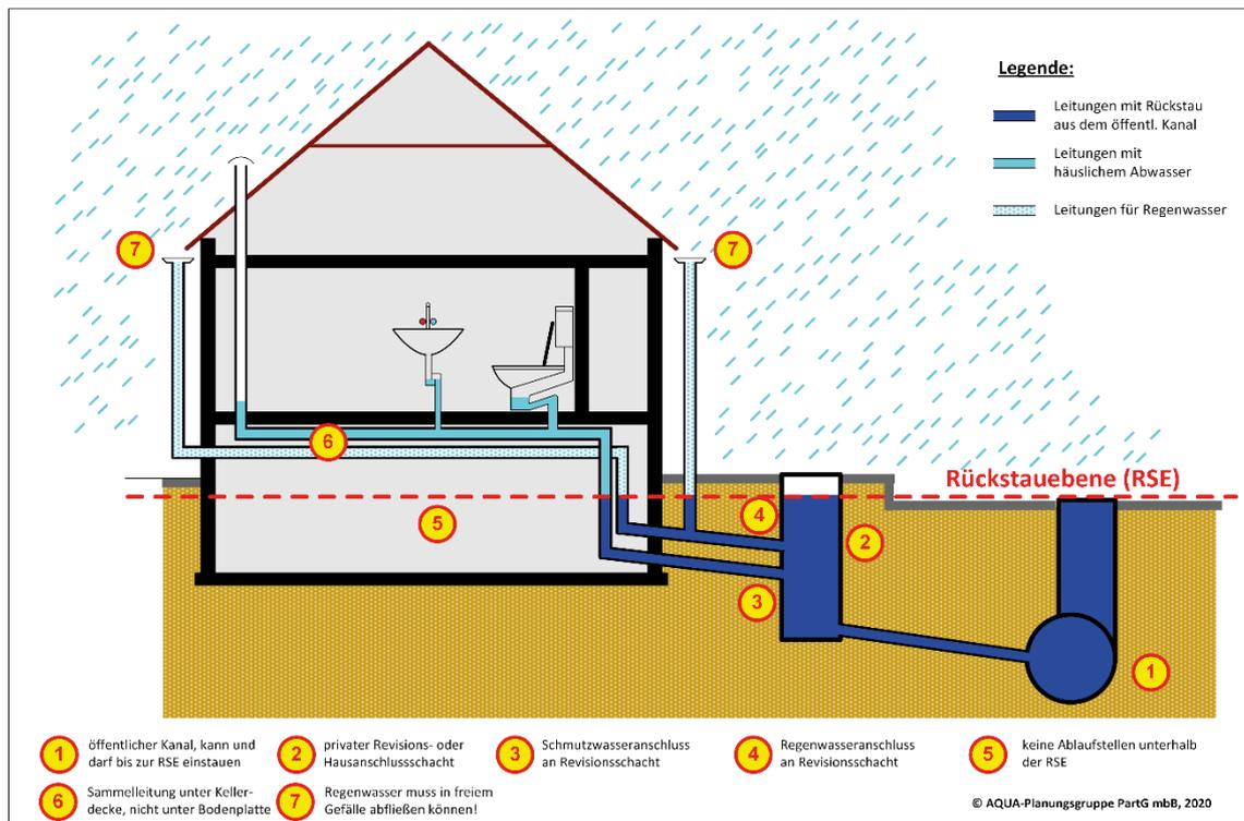
Für Gebäude ohne Keller stellt diese Situation in den meisten Fällen den Normalfall dar. Ein Rückstauschutz wird bei diesen Gebäuden erst dann erforderlich, wenn der Erdgeschossfußboden unterhalb der Rückstauenebene liegt.
