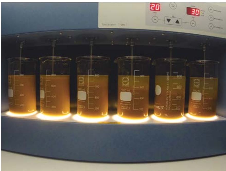
Flockungsversuch mit dem Flockungsmittel Emfloc KA 3 in aufsteigender Dosierung von links nach rechts
