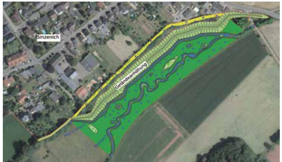
[2.6] Übersichtslageplan für die Hochwasserschutzmaßnahme in Sinzenich
