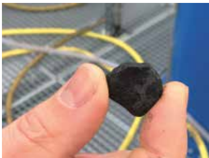
Verkanteter Stein im Absperrschieber
